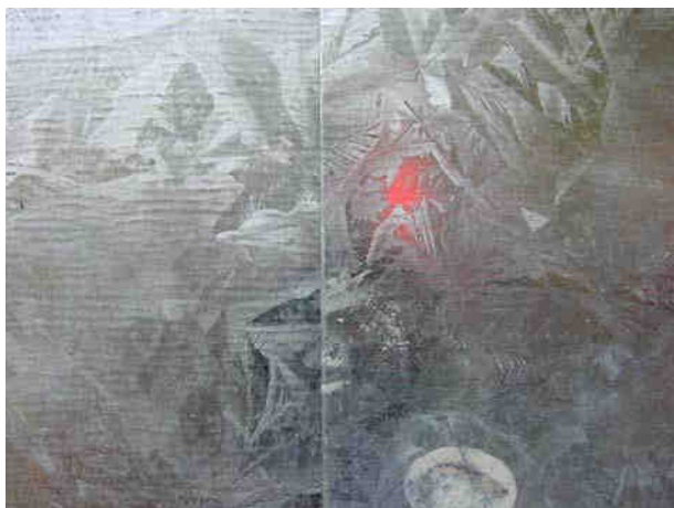
Bild II: Feuerverzinktes Blech mit Zinkblume
