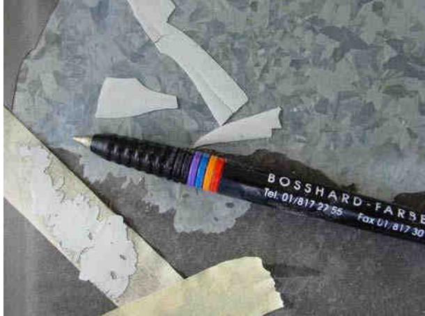
Bild IV: Versprödeter Anstrichaufbau auf Alkydharzbasis
